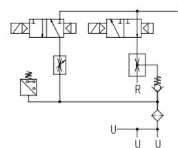
P=CONNESSIONE ARIA COMPRESSA      R=SCARICO      U=CONNESSIONE VUOTO
